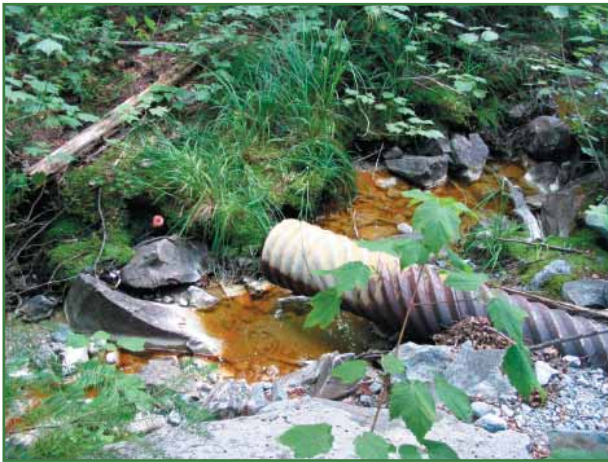
Présence de matières en suspension dans l'eau du ruisseau, en aval de la foreuse
