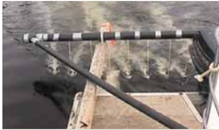
Ponton modifié pour le chaulage des lacs
